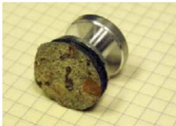
그림 7: 콘크리트 기질의 결합 실패를 보여주는 달리
